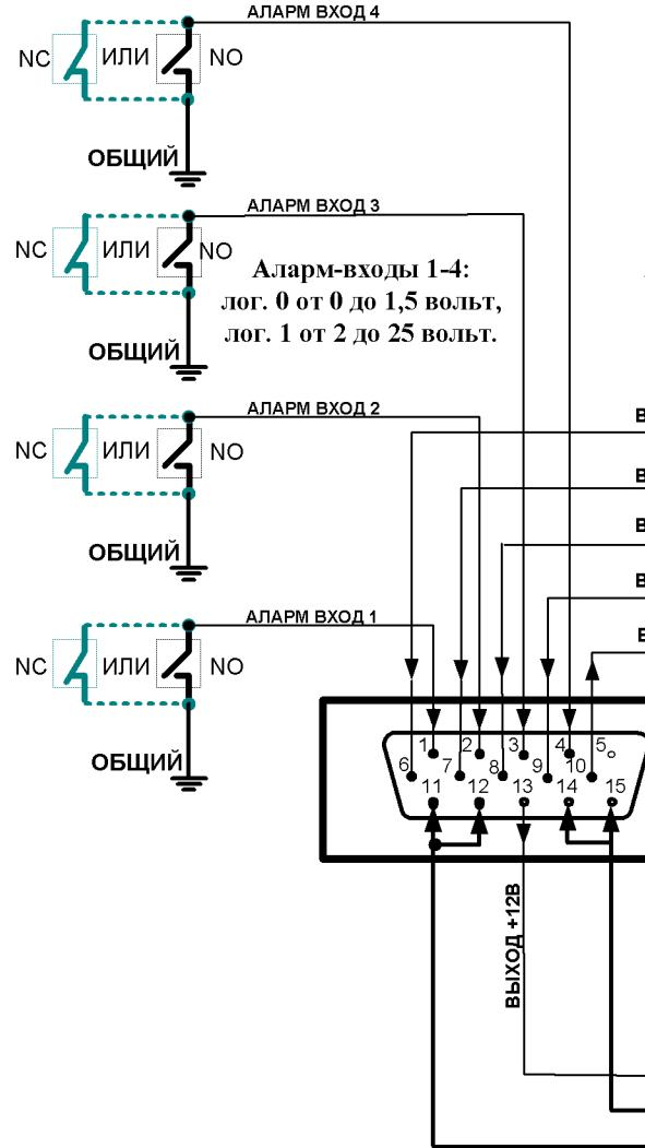
Аларм-входы в авто можно подключать к концевику двери или напрямую к лампочке “открытой двери”. Таким образом, можно производить запись только на остановках. Это удобно для подсчета пассажиров и в десятки раз увеличивает время полезной записи.
